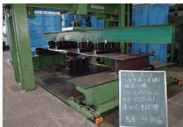
・集中荷重試験写真(製品曲げ・破断試験)
